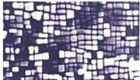
Eine Superlegierung auf Nickelbasis unter dem Elektronenmikroskop. (Foto: Friedrun Reinhold)
