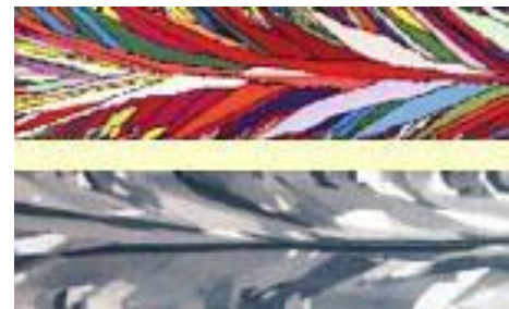
Simulation der Kornstruktur in abgekühltem Metall (oben) und Querschnitt durch einen unter echten Bedingungen gegossenen Metallstab (unten). (Foto: Friedrun Reinhold)
